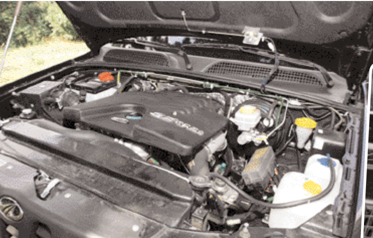
A motorsportok terén szép sikerekkel büszkélkedő AVL mérnökiroda közreműködésével kifejlesztett 2,5 literes, soros, négyhengeres, turbófeltöltős erőforrás olyan korszerű megoldásokat vonultat fel, mint az elektronikus vezérlésű, közös nyomócsöves befecskendezés és az Euro 4 norma teljesítéséhez a kipufogógáz-visszavezetés
