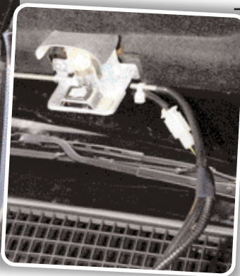
Indiában sokszor az út mentén „szervizelik” a járműveket, így nem meglepő, hogy szériatartozék a motortér-világítás. Fényereje persze nem vetekszik egy szerelőlámpával
